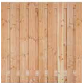
BRECHT RECHTSCHERM - GESCHAAFD Lariks/douglas onbehandeld, RVS geschroefd Planken: 1,7x14 cm, regels: 1,7x14 cm 180x180 cm - 1003873
