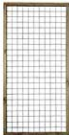
WESEL TRELLIS, STALEN RASTER IN HOUTEN FRAME Naaldhout, Celfix® verduurzaamd Maaswijdte 7 cm, latdikte: 4,5x4,5 cm, draaddikte: 0,4 cm 90x180 cm - 1003045
