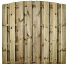
LEUVEN TOOGSCHERM - GESCHAAFD Naaldhout, Celfix® verduurzaamd, RVS geschroefd Planken: 1,4x14 cm, regels: 1,8x7 cm 180x180 cm - 1004050
